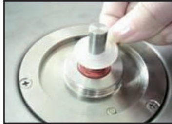
2. Entnahme der weißen Dichtung (Kolloid) von der Zentralwelle des Motors
