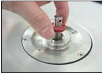
4. Entnahme der roten Dichtung (Kolloid) mit der Hand
