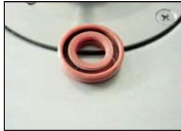
5. Umdrehen der roten Dichtung (Kolloid)
