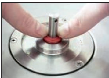
7. Aufsatz der geschmierten roten Dichtung (Kolloid) auf die Zentralwelle des Motors
