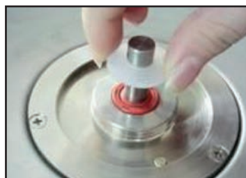
8. Einsatz der weißen Dichtung (Kolloid) auf die Zentralwelle des Motors
