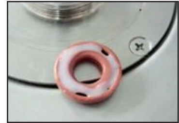
6. Schmieren der Rückseite der roten Dichtung (Kolloid)
