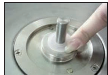
9. Sicherung der korrekten Platzierung der roten – und weißen Dichtung (Kolloid)
